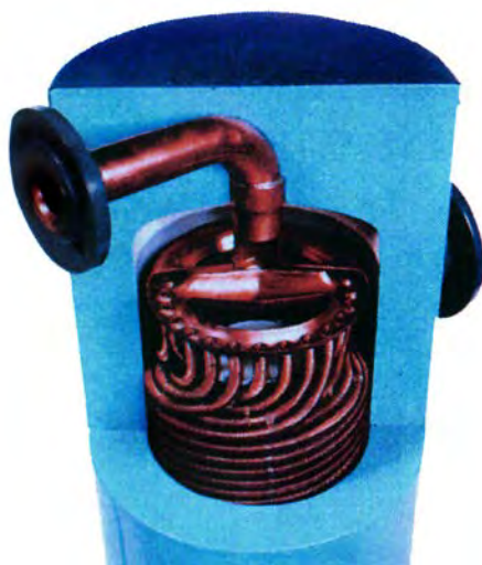
Размещение трубного пучка внутри кожуха
