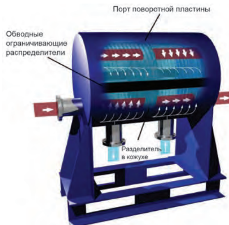
Схема течения теплоносителей в многоходовом теплообменнике AlfaDisc.
